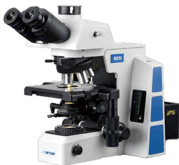
Реализация режимов работы в светлом и темном поле, эпифлуоресценции, поляризации, дифференциально-интерференционного контраста. Доступные объективы 10x, 20x, 40x, 50x, 100x, 150x
