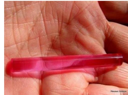
Лазер состоит из трех основных частей: активного (рабочего) вещества, резонансной системы, представляющей две параллельные пластины с нанесенными на них отражающими покрытиями, и системы возбуждения (накачки), в качестве которой обычно используется неоновая лампа-вспышка.
