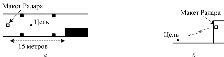
Рис. 2. Схема проведения экспериментов: а – коридор внутри здания; б – пустая парковка перед зданием
