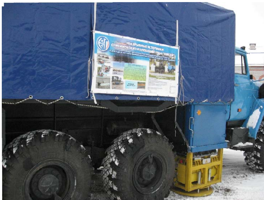
Рис. 2. В правом нижнем углу отчетливо виден импульсный электромагнитный источник «Енисей», установленный на автомобиле «УРАЛ»
