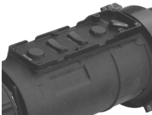
Рис. 1. Внешний вид органов управления прицелов AN/PAS-13D. Видны характерные борты вокруг кнопок, препятствующие непроизвольному нажатию
